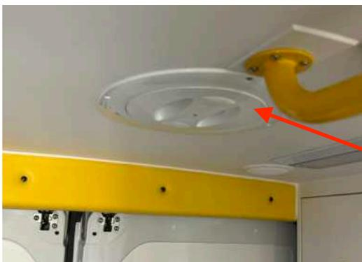
Sortie de ventilation par le toit. En
