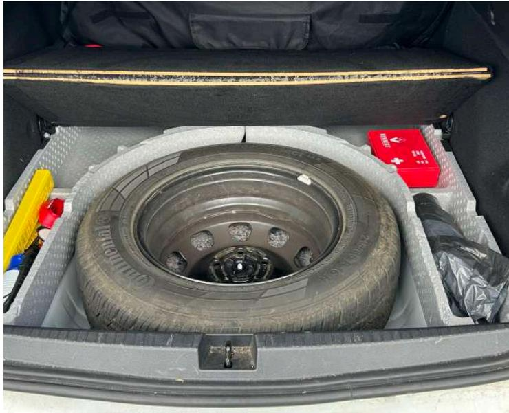
La roue de secours se trouve sous le sol du coffre, il suffit de le soulever.
