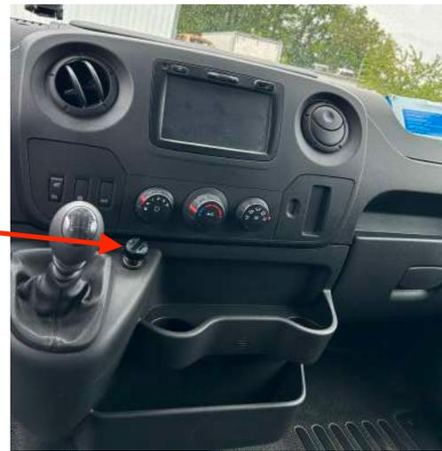
Une tension comprise entre **12,4 et 12,7** volts indique que la batterie est en bon état et chargée
